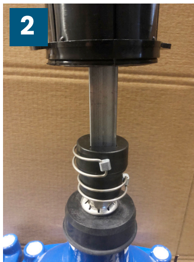
2. Montera garnityrets fyrkantsrör i spindelhylsan. Använd sprintarna som medföljer spindelhylsan.
