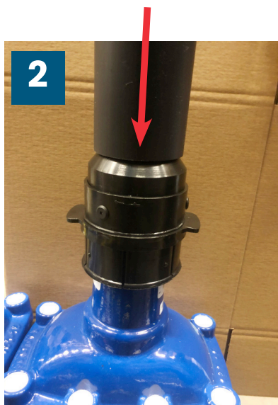
3. Skjut ner garnityret över plastadaptorn tills det klickar till.
