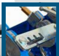
Rörliga distanser tillåter val av svetsposition
